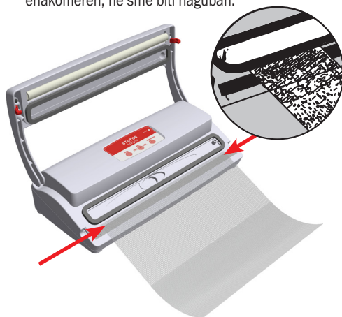
Slika 2: Pri varjenju mora biti vrečka na varilnem traku - nameščena naj bo do črnega tesnila kot prikazujeta puščici (in ne čez).
